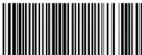
Code 128 ist ein langenvariabler, alphanumerischer Code mit einer hohen Informationsdichte. Drei verschiedene Zeichensatze (A, B und C) erlauben es, innerhalb des Barcodesymbols den Zeichensatz zu wechseln. DPD benotigt den Zeichensatz C fur den numerischen Anteil des Barcodes. Der alphanumerische Anteil wird durch den Zeichensatz B dargestellt.
