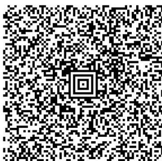
Das Symbol ist auf einem quadratischen Raster mit einem Ziel („Bullauge“) in der Mitte für die Lokalisierung des Codes angeordnet. Die Daten werden in konzentrischen Quadratringen um das „Bullauge“ herum codiert. Dadurch wird keine Ruhezone benötigt.
